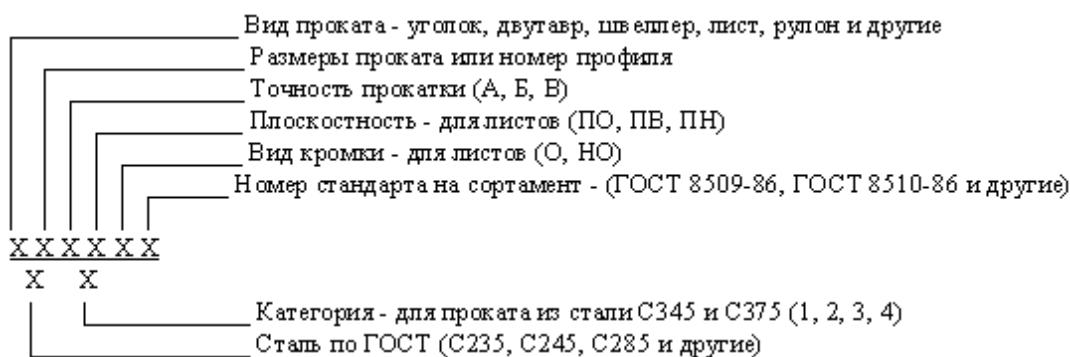
Прокат угловой равнополочный, обычной точности прокатки (В), размерами 75x75x6 мм по ГОСТ 8509-86, из стали С245 по ГОСТ 27772-88
